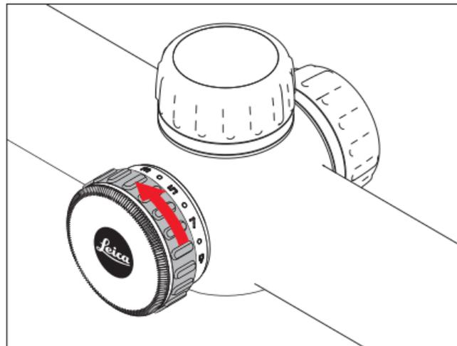
Con la stessa ghiera è possibile regolare la luminosità del punto luminoso in 9 livelli, per evitare disturbi durante il puntamento in condizioni di luce ambiente diverse:
