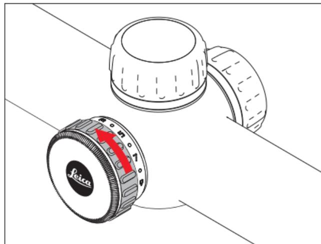
С помощью того же кольца можно регулировать яркость (9 уровней) светящейся точки, чтобы при различном окружающем свете предотвратить ошибки во время прицеливания:
