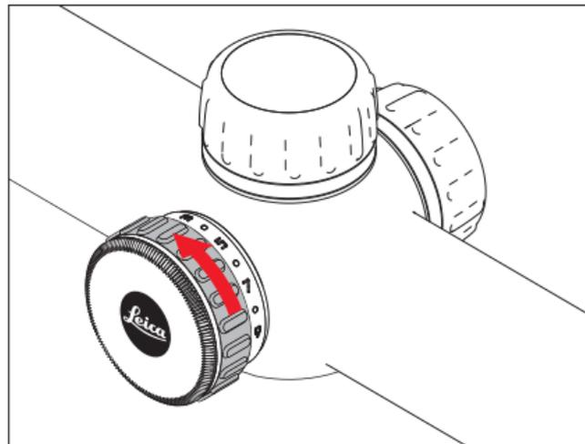
La luminosité du point lumineux peut être réglée en 9 incréments avec la même bague pour éviter une détérioration lors de la visée en cas de lumière ambiante variable :
