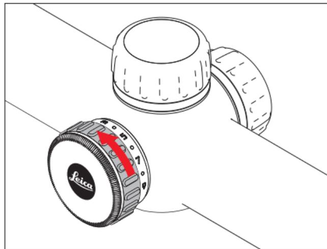
Mit dem gleichen Ring lässt sich Helligkeit des Leuchtpunkts in 9 Stufen regeln, um bei unterschiedlichem Umgebungslicht eine Beeinträchtigung während des Visierens zu vermeiden:
